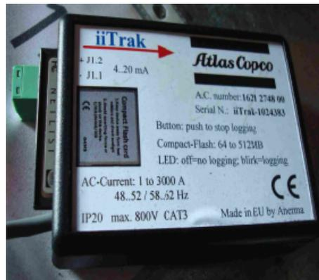
圖 8 iiTrak 負載擷取量測設備
